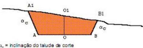
$\alpha_c$  = inclinação do talude da corte
