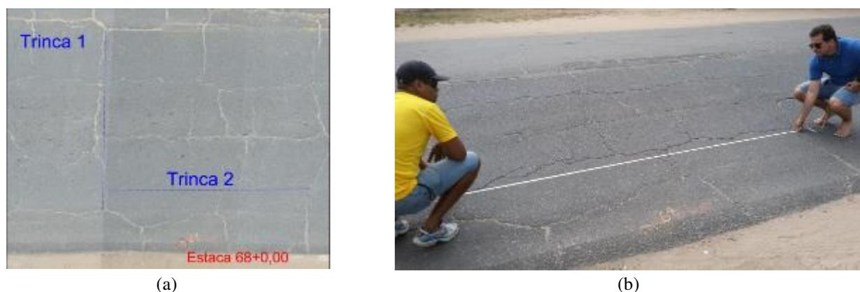
Figura 9 – (a) Medição no software sobre o mosaico e (b) levantamento da extensão longitudinal da trinca em campo
