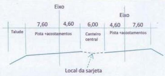
A imagem acima mostra um trecho da BR-408/PE que foi recentemente duplicado. No croqui é mostrada uma seção transversal tipo de um segmento de aterro com 565,00m de extensão.
